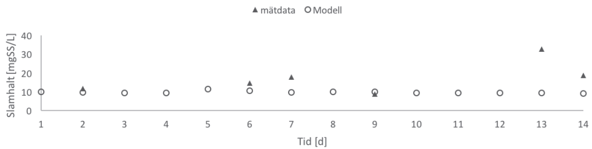
Figur B7: Modellerad och uppmätt slamhalt (flödesproportionerligt dygnsmedelvärde) i utgående vattenfas från eftersedimentation från linje 1 (övre) och 2 (nedre) under valideringsperioden.
