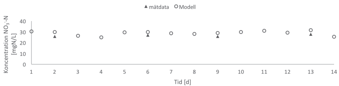
Figur B3: Modellerad och uppmätt nitratkvävehalt (flödesproportionerligt dygnsmedelvärde) i utgående vattenfas från eftersedimentation från linje 1 (övre) och 2 (nedre) under sommarperioden.
