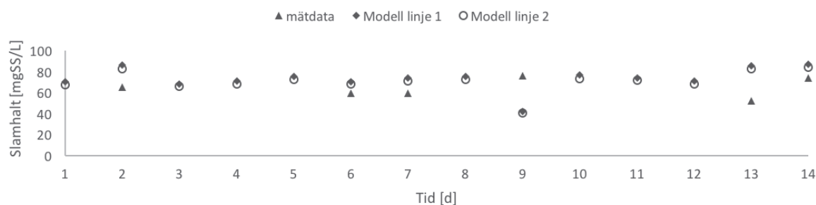
Figur 6.1: Modellerad slamhalt ut från försedimentation jämfört med mätdata under den valda sommarperioden. Alla punkter är flödesproportionerliga dygnsmedelvärden.
