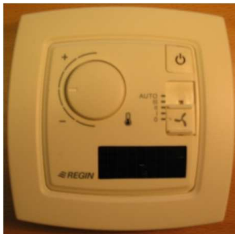
Figur 4: Den modifierade rumsenheten med solcellen nere till höger.
