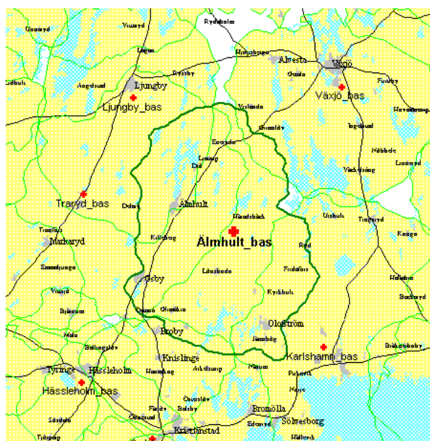
Figur 9 - Täckningskarta för Älmhult basstation i Mobitexnätet. Den starka gröna linjen är det område Älmhult bas täcker (rött kors). De andra röda kors gäller andra stationer och de ljusgröna linjerna respektive täckningsområdet.
