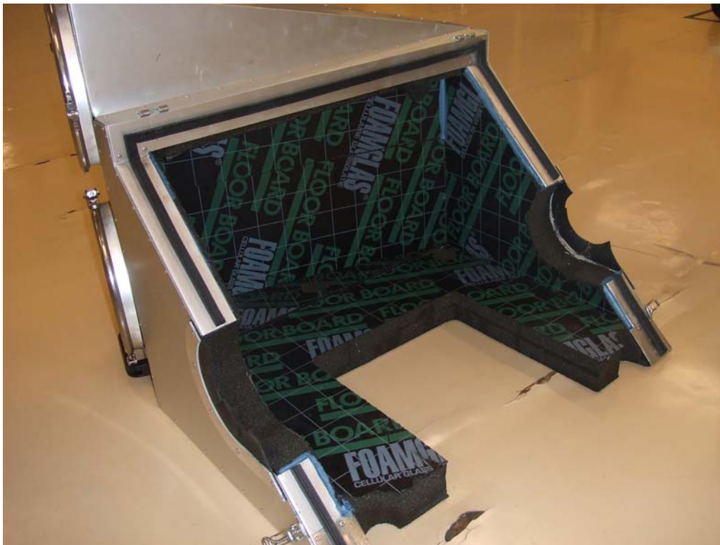
Figur 5, Temperaturhuv med ny isolering
