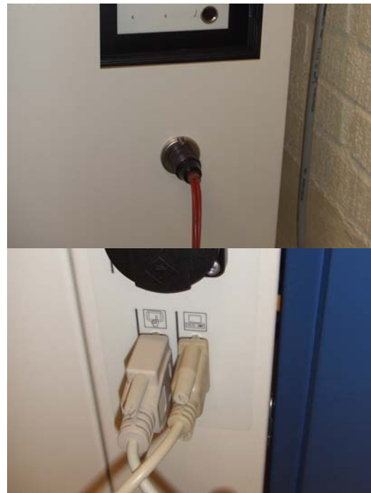
Figur 5, Anslutning för Pt100 och RS232
