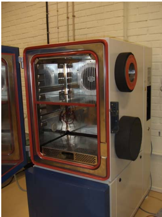
Figur 4, Temperaturskåp med skiljeplåt
