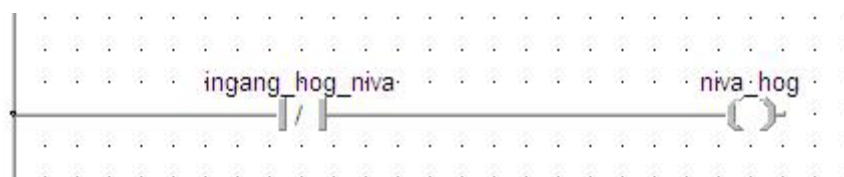
Figur 26. Kontroll av överfyllnad i diskhon.
