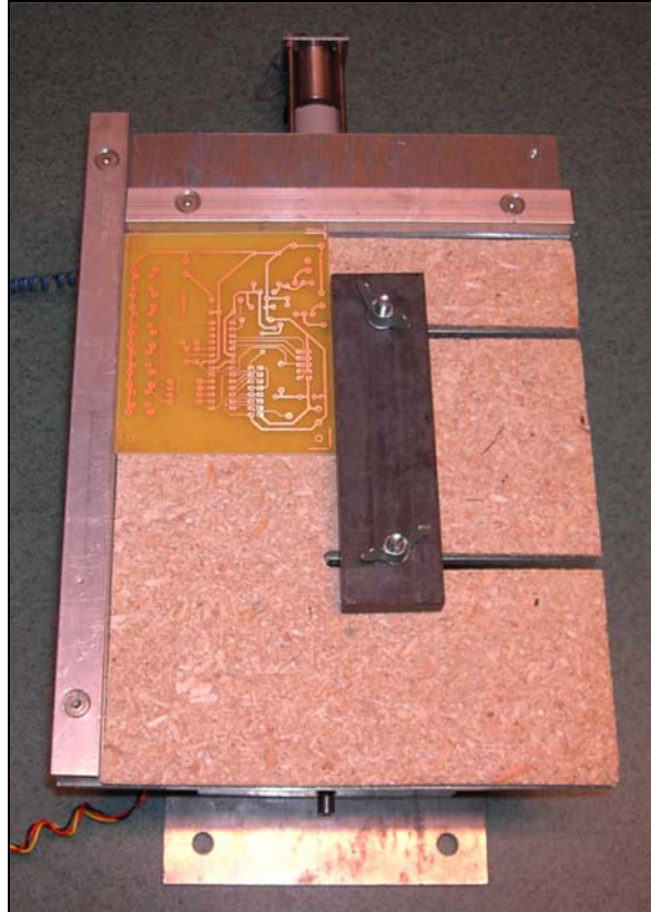
Figur 2.3 – Exempel på hur kretskortet kan spännas fast inför borring
