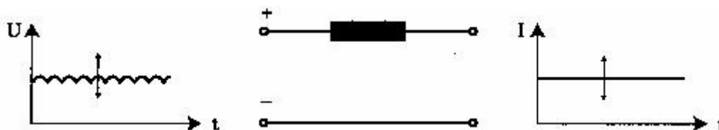
Figur 11. Variabel likströmsmellankrets, med spole som omformare.
