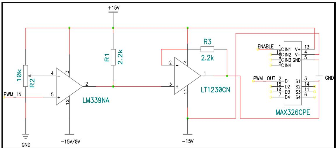
**Figure 3.4-2: PWM circuit**
