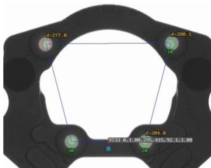
Figur 24: Avståndsmätning av tre sträckor på en produkt av typ 9733. Sträckorna är markerade med streck i bilden och avståndet anges i antal pixlar.
