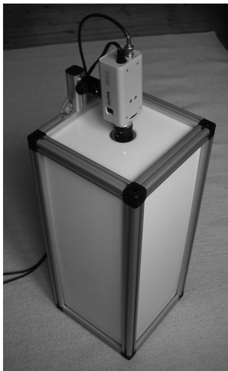
Figur 17: Ljussättningslådan sedd snett ovanifrån. Tanken är att halvfabrikatet som skall undersökas placeras i öppningen som är vänd mot golvet på bilden. Den vita plasten sprider ljuset som släpps igenom och skapar en jämn belysning inuti lådan.
