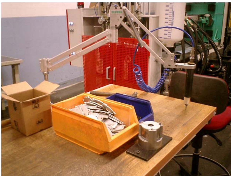
Figur 2: En manuell monteringsstation. En färdig produkt sitter i fixturen till höger. I den gula lådan ligger lock och i den blå lådan ligger skruvar. Till höger syns skruvdragaren.
