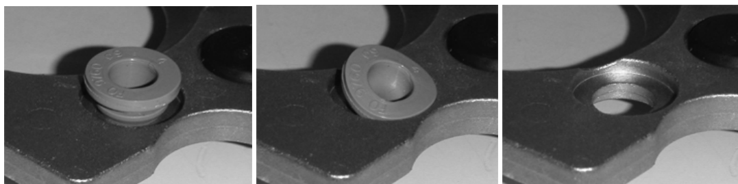
Figur 23: Exempel på de tre olika typer av fel som uppkommer då gumminapparna trycks i.
