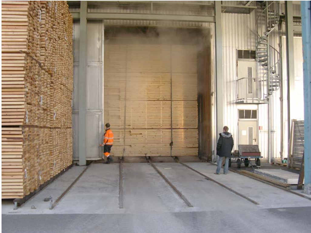
Figur 2.1. Ett virkespaket har just torkats färdigt och är på väg ut ur torkkammare 20 på Hemmingssons sågverk i Vimmerby.
