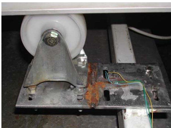
Figur 8.1 Applicerad ½-brygga på en prototypupplagring. Motsvarande trådtöjningsgivare som kan skyntas på ovasidan finns också på undersidan.
