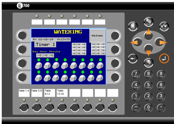
Figur 6.4 Inställning av timrar för bevattning. Det finns 8st timrar som man väljer i den rullgardin som kommer upp då man på verkar Timer 1. Om operatören sedan fyller i dag, timme och minut och trycker in de knappar som motsvarar de bord han vill bevattna kommer bevattningen att starta på utsatt tid under förutsättning att borden finns på rätt plats.
