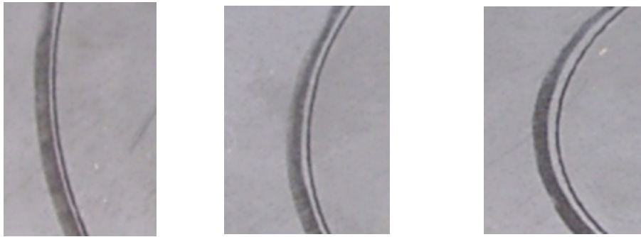
Figur 3.5 Cirklar med olika radie. Tunna linjen är svetsen och breda linjen är markeringarna efter hjulet. Radien från vänster 112.5 mm, 62.5 mm 37.5 mm. Man kan konstatera att avvikelsen ökar med minskad radie.
