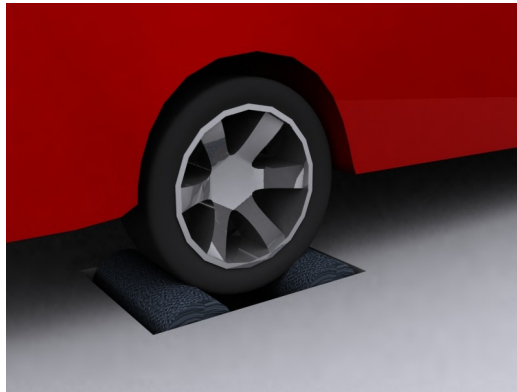
Två roterande cylindrar som överför moment till hjulet. Laddning sker sedan genom regenerering hos elmotorerna.
