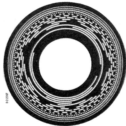
Kodskiva till en roterande absolut pulsgivare
